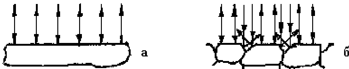
Рис. 3. Схема отражения световых лучей от поверхности полированного (а) и подвергнутого травлению (б) микрошлифа.
