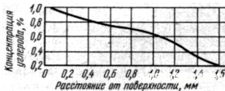
Рис. 1. Изменение концентрации (%) углерода в цементованном поверхностном слое.
