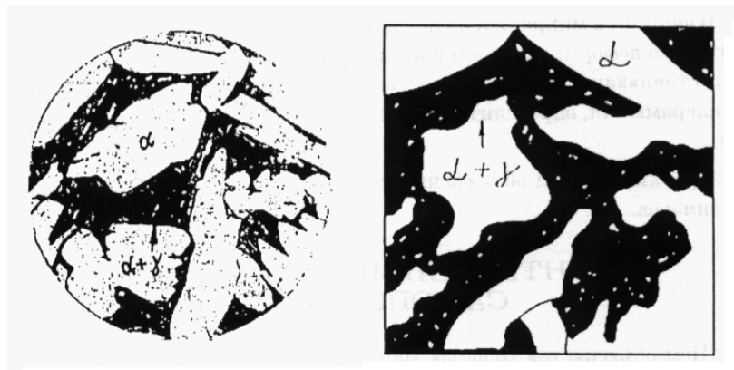
Рис. 5. Микроструктура литой двухфазной бронзы (справа - схематическое изображение)
