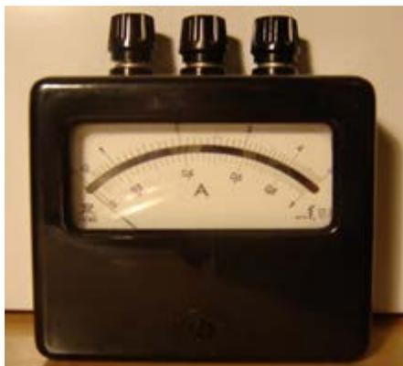
Принцип работы основан на взаимодействии магнитного поля неподвижной катушки с сердечником из ферромагнитного материала, внесенного в это поле.
