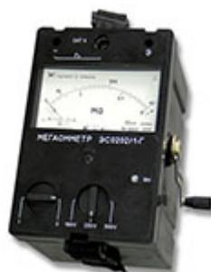
Принцип работы основан на действии электростатического поля, созданного между двумя неподвижными электродами, на подвижный электрод.
