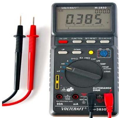
Основой цифрового вольтметра является аналого-цифровой преобразователь (АЦП). В настоящее время имеется множество схемотехнических принципов построения АЦП, однако общим из них является сравнение измеряемой величины с набором эталонов. Основными характеристиками АЦП являются точность преобразования (число разрядов в выходном коде) и быстродействие.
