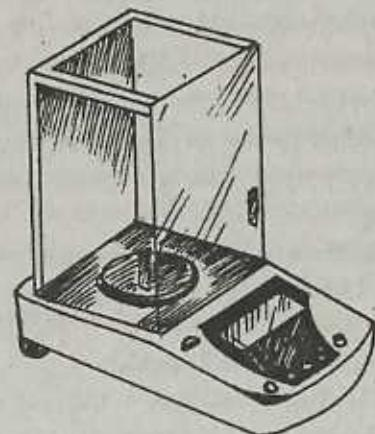
Рис. 2. Аналитические весы (одночашечные) серии was
