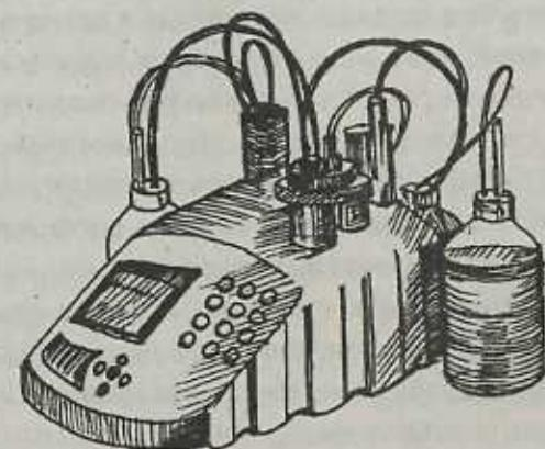
Рис. 3 Автоматический титратор
