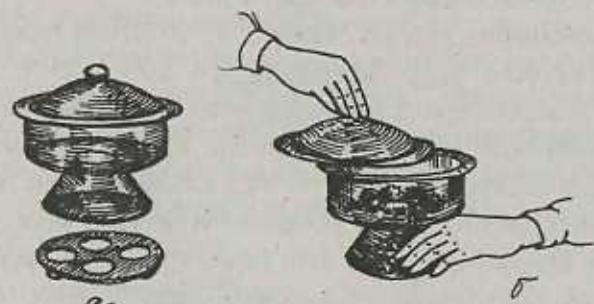
Рис. 9 Эксикатор (а) и правила его использования (б, в)
