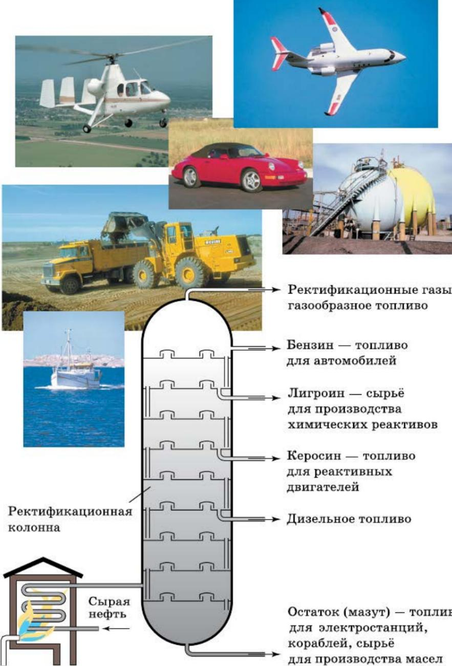
**Рис. 35. Схема установки (ректификационной колонны) для непрерывной перегонки нефти и области применения нефтепродуктов**
